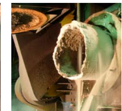
Der Tiegel wird ausgedrückt
