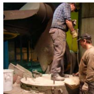
Der Tiegel wird mit Hinterfüllmasse mittels Verdichter-Lanze fixiert.
