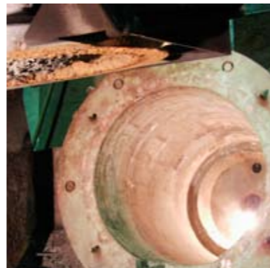
Der Ofen wird gereinigt und der Spulenputz wird überprüft.
