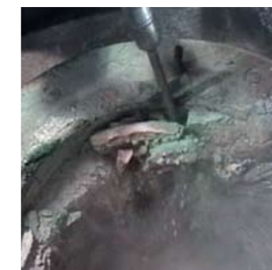
Zunächst wird der obere Tiegelrand mit dem Preßlufthammer entfernt.
