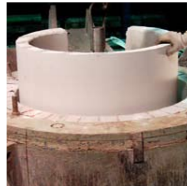
Der Dorit-Fertigtiegel wird mit Hilfe des Tiegelhebergerätes eingesetzt.
