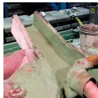
Die Gießschnauze wird den jeweiligen Gegebenheiten angepaßt.
